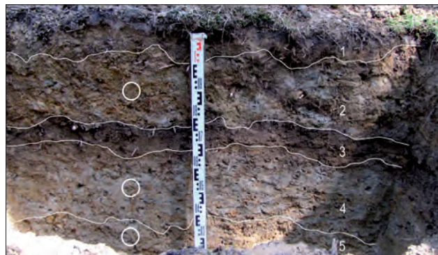
Obr. 34. Lokalita č. 13 Netřebice, les Háj, trať V prádle. Dokumentovaný půdní profil s vyznačením vrstev, ze kterých byl odebrán vzorek na šlich. Foto Petr Hrubý 2013. Fig. 34. Locality No. 13, Netřebice, Háj forest, V prádle route. Documented soil profile with marked layers where the sample for heavy minerals prospecting was taken. Photo by Petr Hrubý.
