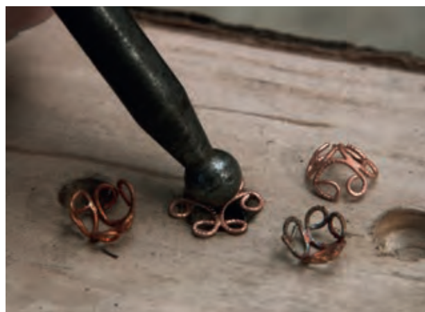
▲ Obr. 3. Výroba filigránních polokoulí.
