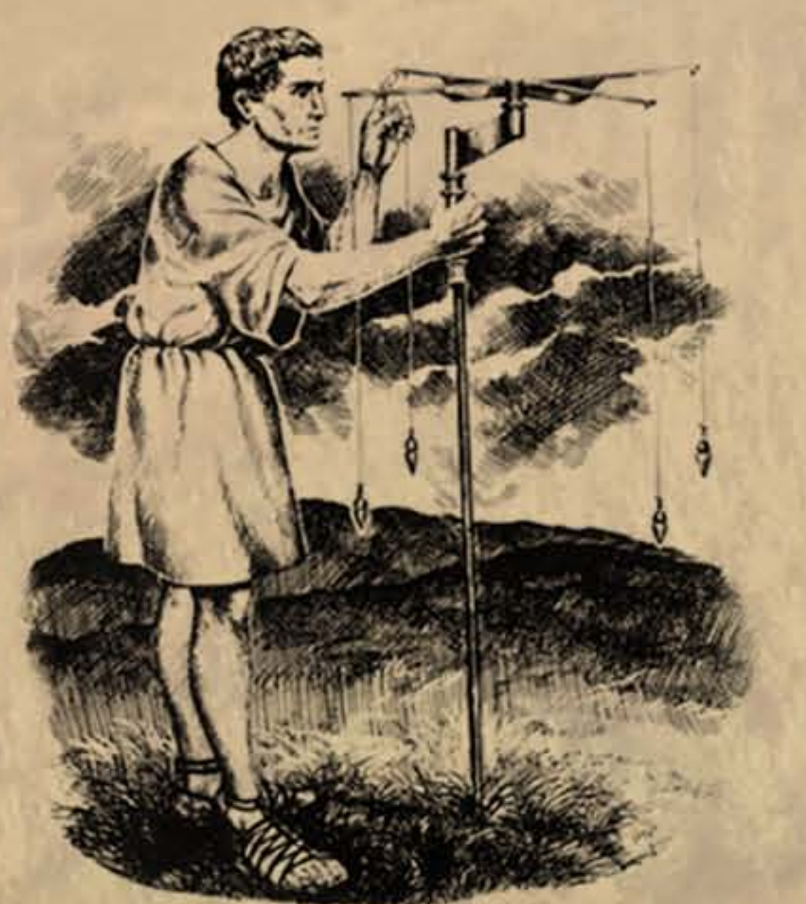
ZEMĚMĚŘIČ VYMĚŘUJÍCÍ PŮDORYS TÁBORA NÁSTROJEM NA MĚŘENÍ PRÁVÝCH ÚHLŮ (TZV. GROMMA)
